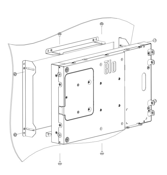
FRONT MOUNT BEZEL KIT P/N E711274 FOR INTELLITOUCH, ACCUTOUCH, AND SECURETOUCH MODEL ONLY
